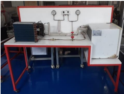
Fig. 4 Freezer Trainer Unit
